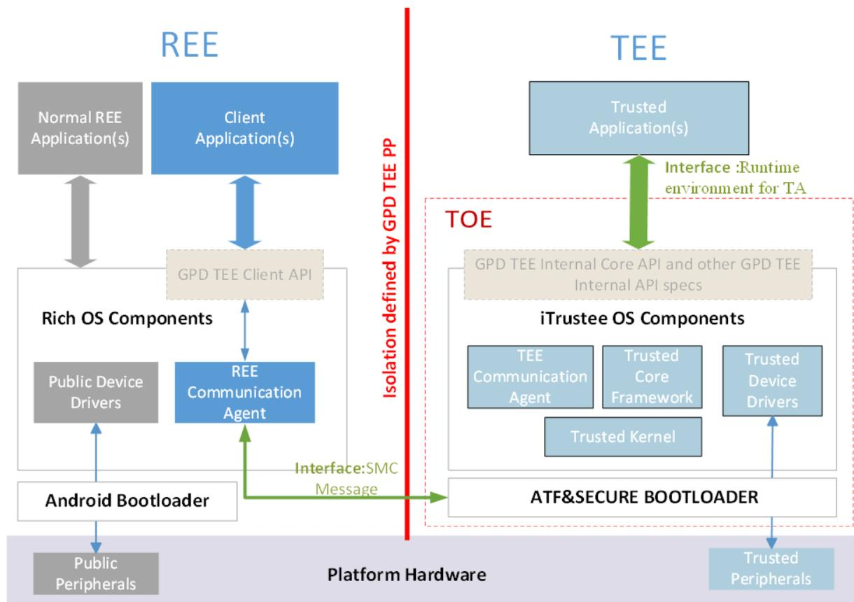
Figure 1 : Architecture logiciel et *firmware* du produit
